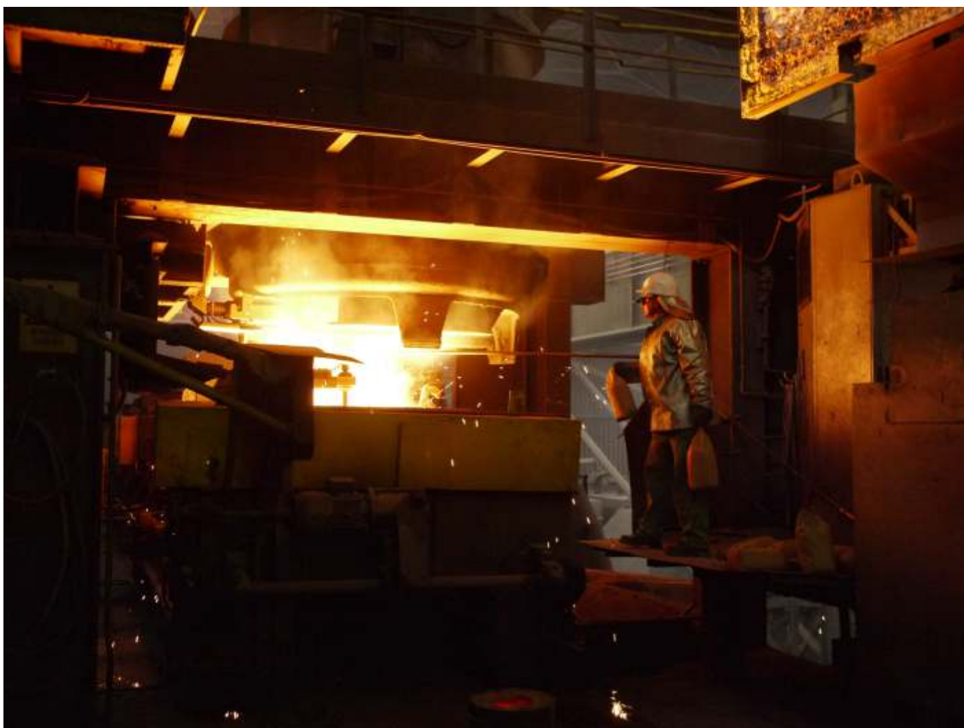
Fotografija: litje jekla iz livne v vmesno ponovco na obstoje i konti napravi
